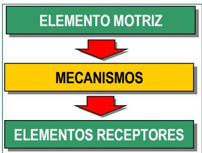
Según su función los mecanismos se pueden clasificar en dos grandes grupos, según transmitan el movimiento producido por un elemento motriz a otro punto, o cambien el tipo de movimiento. Este curso nos centraremos en los primeros (los de transmisión), y veremos únicamente algunos ejemplos de los segundos (de transformación).
